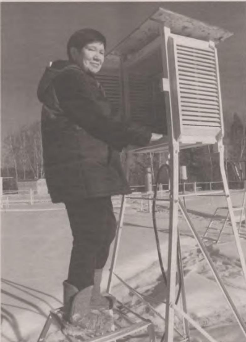
■ Татьяна МИЦУРА и психрометрическая будка. Прибор придумали лет сто назад, да с умом: дверца устанавливается строго на север, чтобы не пропускать солнечные лучи.
