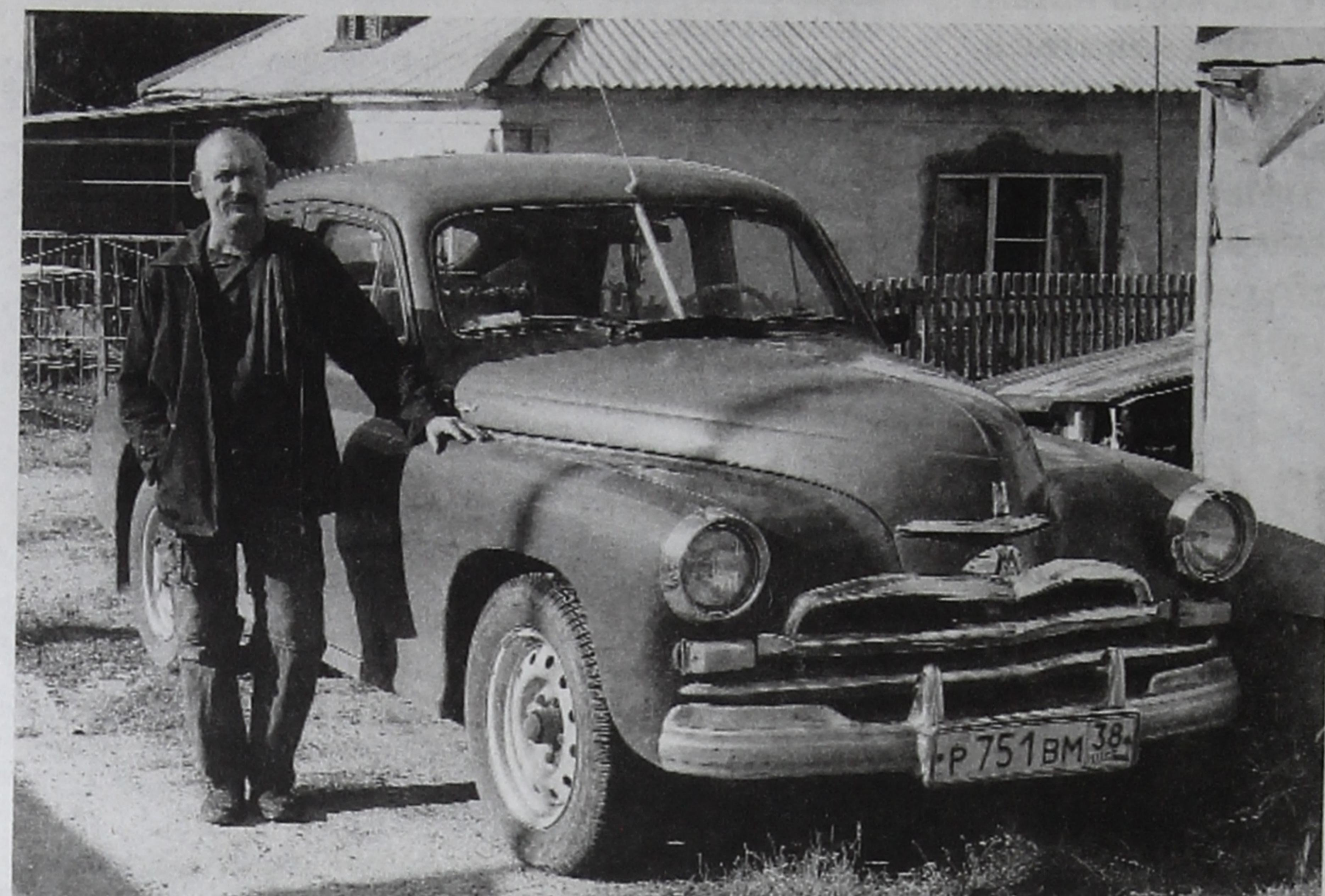
■ Машина на полураме. Кузов луженый (современные авто шпаклюют, а у этой все швы кузова пропаяны оловом). Полный вес автомобиля 2 180 кг. Двигатель объемом 2,12 л. Максимальные обороты 3 800. Время разгона 53 секунды. 52 лошадиные силы. Максимальная скорость 105 км/ч.
