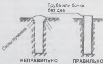
лические бочки (лучше поставленные одна на одну без дна и залитые бетоном) и самый простой вариант - это деревянный столб. При изготовлении фундамента на деревянных сваях необходимо помнить и выполнить ряд реко-
