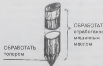
мендаций. Прежде всего такой тип фундамента пригоден для небольшого одноэтажного строения. Сама древесина пропитывается или специальными пропитками, останавливающими процесс гниения или можно обильно пропитать
