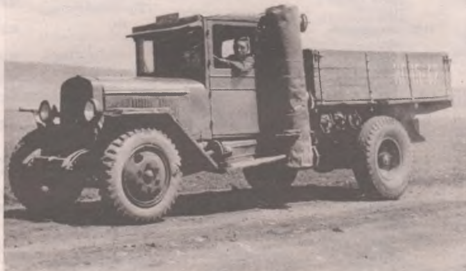
Грузовик-газогенератор работал на дровах
