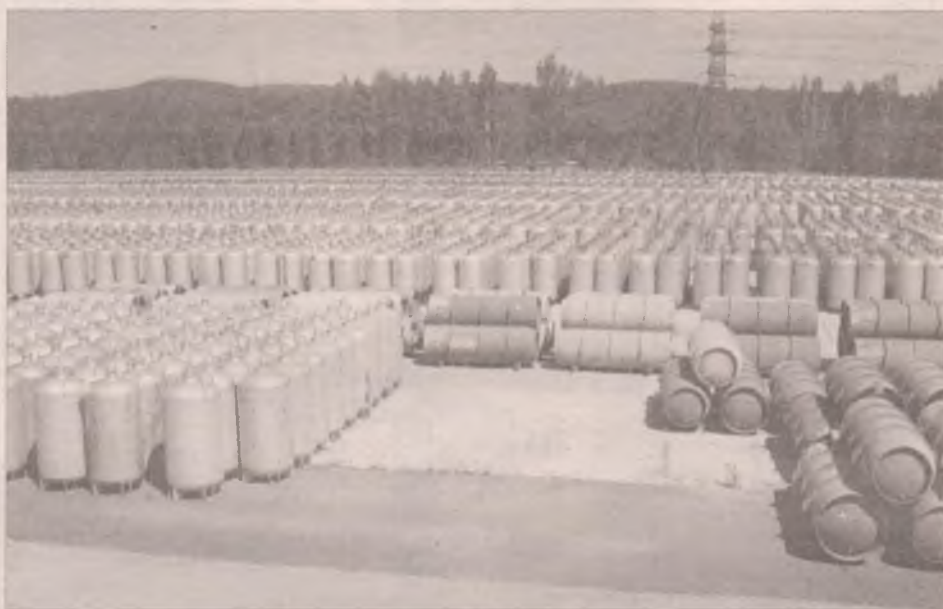
Мировая практика - контейнеры с ОГФУ хранятся на открытых площадках
