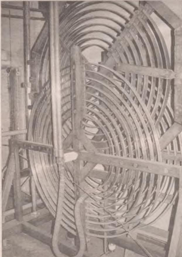
Переменный конденсатор радиопередатчика выглядит внушительно
