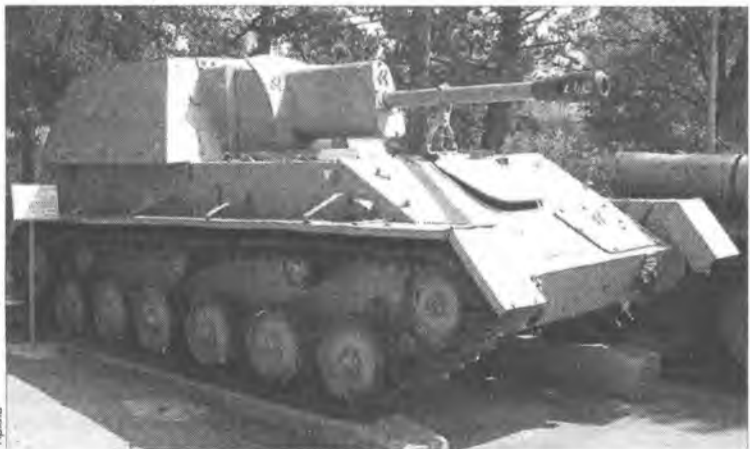
Самоходно-артиллерийская установка Су-76М Годы выпуска 1942-1945 Вес 14,6 тонны Экипаж 4 человека Мощность двигателя 2х70 лошадиных сил Скорость 45 километров в час Запас хода 270 километров
