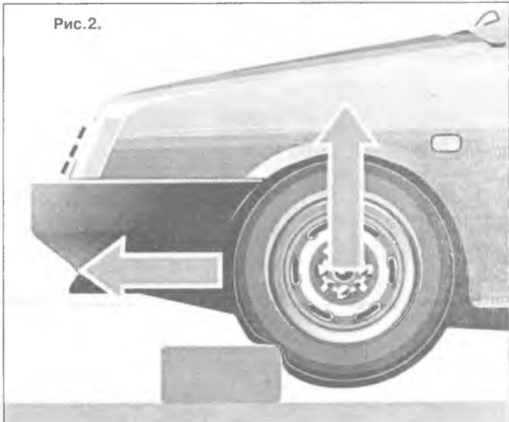
Долгое хранение в мороз делает амортизаторы похожими на палки. Если на таких двинуться по колдобинам с большой скоростью, то подвеска, кузов и сами амортизаторы начнут разрушаться. Гораздо выгоднее медленная езда, чтобы амортизатор плавно гонял застывшую жидкость, разогревая ее. Когда подвеска перестанет ощущаться "дубовой", скорость можно увеличить.
