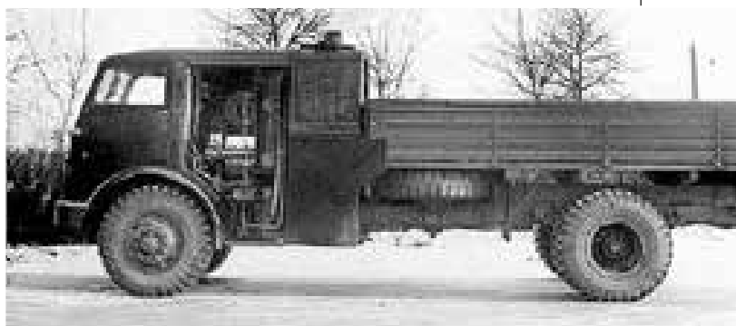
• Послевоенный паровой автомобиль НАМИ-012. За кабиной находилось машинное отделение со смотровым люком.
