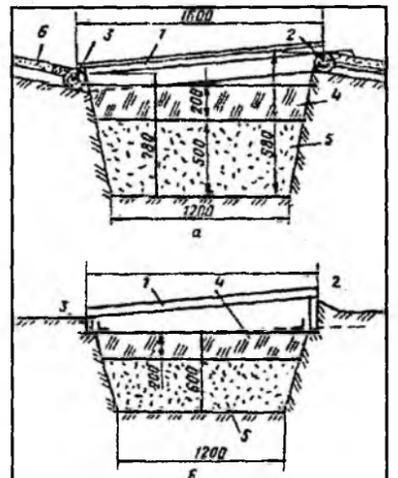
Поперечный разрез русского углубленного парника на биологическом обогреве: а - деревянный; б - бетонный; 1 - рама; 2 - северные парубни; 3 - южные парубни; 4 - грунт; 5 - биотопливо; 6 - лежень
