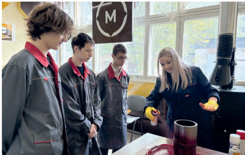
■ Говоря о современных способах диагностики, преподаватель Марина Сивеня наглядно демонстрирует первокурсникам капиллярный метод дефектоскопии
