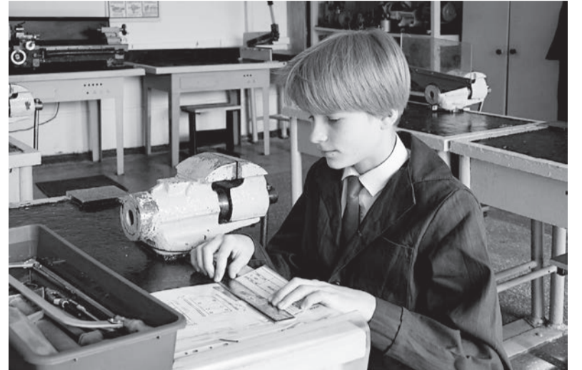
■ Матвей Неумоин знает, что, прежде чем выточить металлическую задвижку, необходимо начертить разметку, выверенную до доли миллиметра
