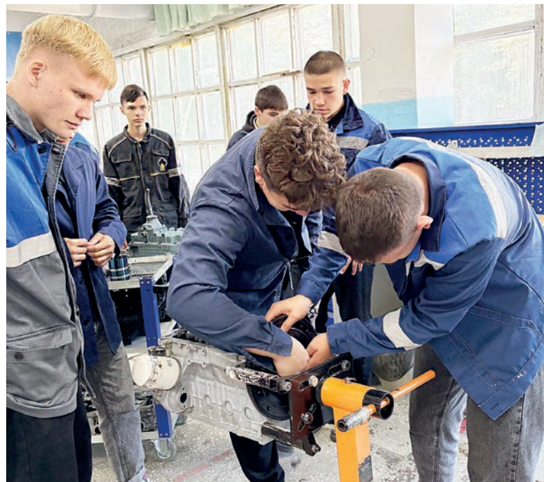
■ Студенты 2-го курса учатся производить установку маховика на 16-клапанный двигатель. Такие моторы - сердце автомобилей модельного ряда «Лада»
