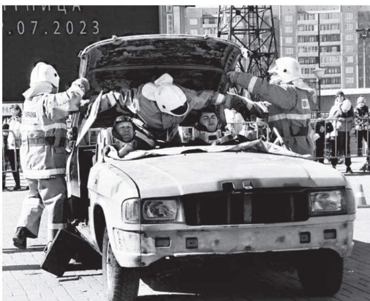
Во время демонтажа крыши автомобиля один из спасателей накрывает водителя и пассажиров специальным покрывалом, защищающим от осколков выбиваемых стекол
