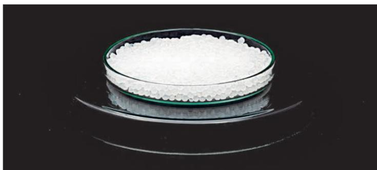
ска плёнки, термоплёнки, пакетов, пищевой многослойной упаковки, тары, скотча, парниковой плёнки. Изделия из полиэтилена высокого давления используют в электроизоляции, химическом и пищевом производстве, в благоустройстве придомовых территорий и детских площадок, в автомобилестроении, строительстве. Трубы из полиэтилена высокого давления отличаются непревзойдённой прочностью и рекомендуются для установки в системах жилищных коммуникаций.
