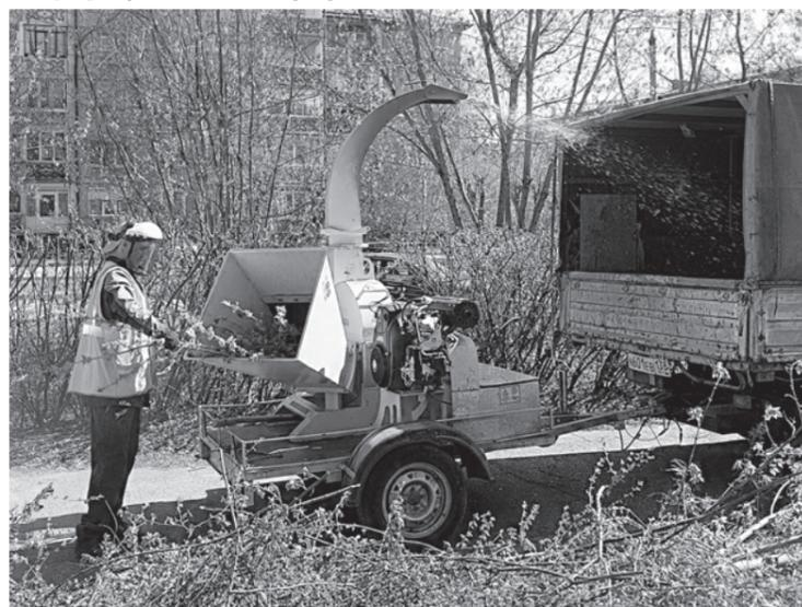
■ Все обрезанные ветки тут же, на месте, с помощью специального агрегата измельчаются в щепу
