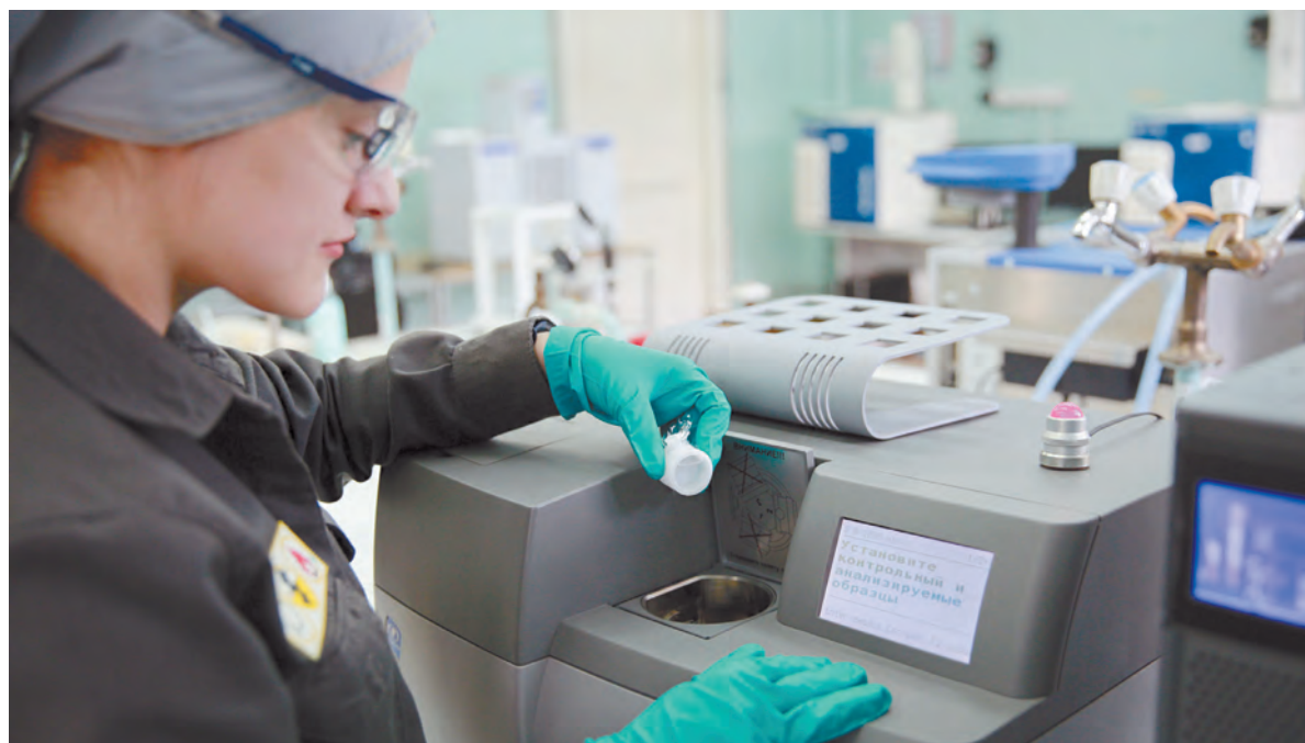
Новый анализатор позволяет определять содержание серы в нефтепродуктах
