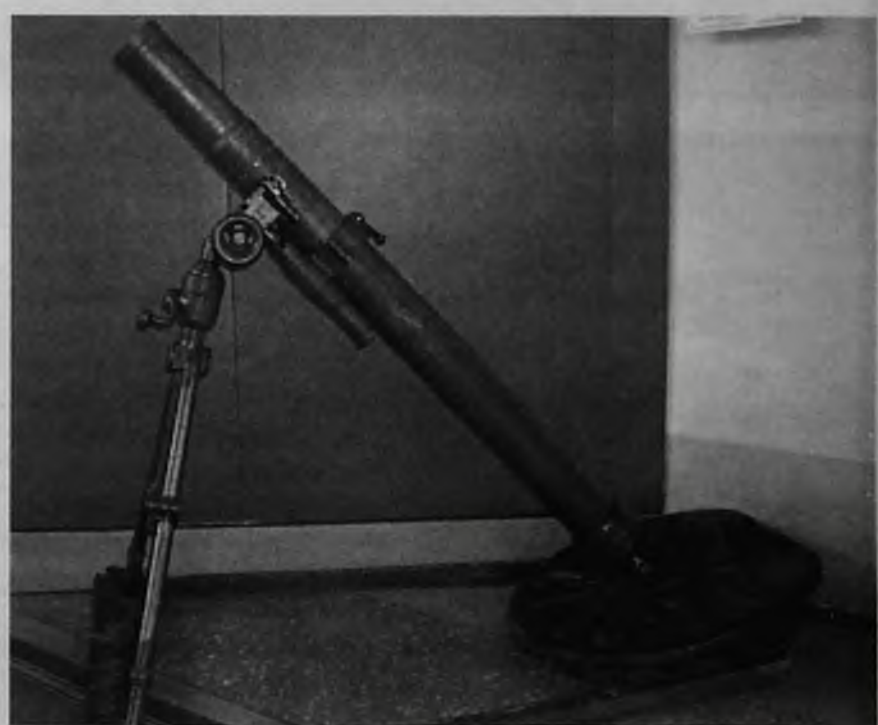
82 мм дульнозарядный батальонный миномет образца 1937 года. Масса мины – 3,1 кг. Начальная скорость мины – 211 м/с. Максимальная дальность стрельбы – 3040 м.
