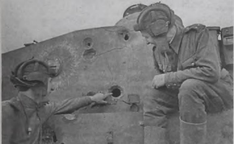
Пробоину в башне «Тигра» сделал обычный броневой снаряд из 76-миллиметрового танкового орудия
