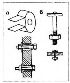
Рис.1. Крепление к тонкой стене: а - скобой из жести; б - винтом с пластиной.
