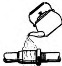
Прежде чем прогреть огнем паяльной лампы неподдающиеся детали водопроводных соединений: трубы, муфты, краны - можно попытаться стронуть их, полив на резьбу крутым кипятком из чайника.
