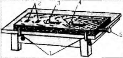
струбцин входят в гнезда, которые должны быть предусмотрены в доске. Накладная доска очень удобна в работе и в домашних условиях может в какой-то мере заменить столярный верстак.
