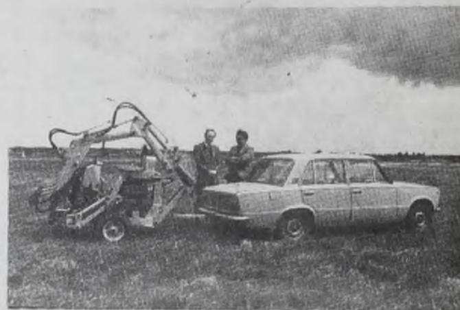
УКРАИНСКАЯ ССР. Группа молодых специалистов конструкторского бюро производственного объединения «Коломысьсельмаш» разработала первый в стране микроэкскаватор М-ЭКС-330. Его масса — 570 килограммов. По техническим параметрам машина соответствует зарубежным аналогам.
