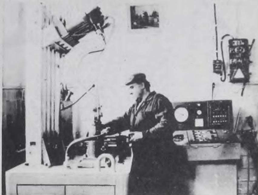
Работа с прибором для проверки топливных форсунок.
