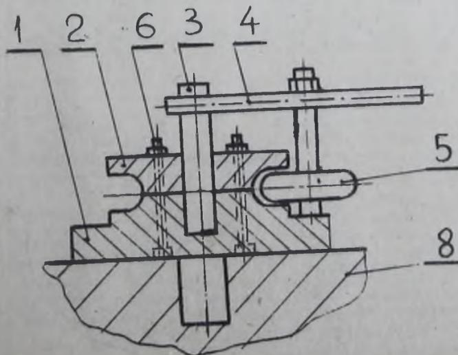
Существующий метод изготовления коушей строп заключается в том, что нагретую стальную полосу укладывают на наковальню и с помощью специального молотка полосу придает желобчатую форму, затем нагретая фасонная полоса огибается вокруг цилиндрической оправки, придавая ей форму коуша. Такой метод изготовления коушей малопроизводителен. Желобчатая форма в процессе огибания, на оправке, искажается. Коуши дополнительно нагревать и вручную подгибать на наковальне.
