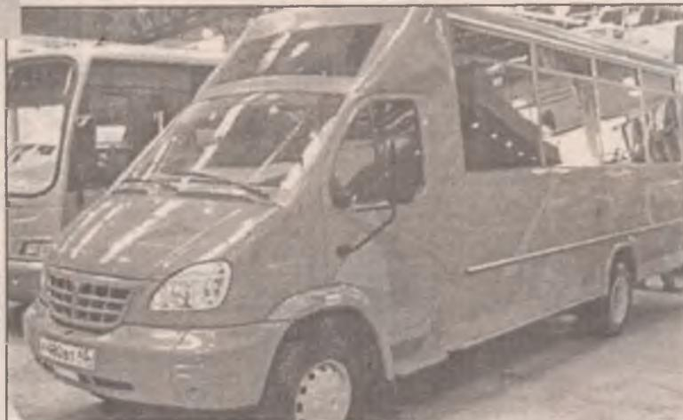
кас сварен из стальных прямоугольных труб и штампованных профилей. Внешняя облицовка крыши и боковин выполнена из оцинкованно-
