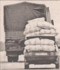
Среди причин аварийности с участием перегруженных легковушек дорожные инспектора отмечают халатность водителей в вопросе крепления груза на багажнике, что монтируется на крыше. Зачастую под давлением встречных потоков воздуха под колеса попутных авто с багажников "планируют" в севозможны в сямики, коробки, диваны и даже хо-
