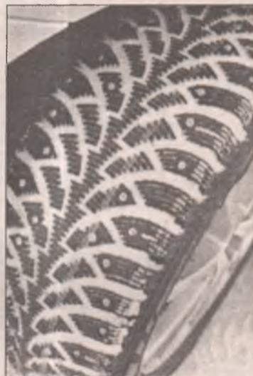
Шипы размещают в "плечевом поясе" протектора – ближе к краям беговой дорожки. В пятне контакта шины с дорогой одновременно находятся от 8 до 12 шипов. Чтобы их работа была эффективной, каждый из "зубов" должен идти по собственному пути, а не по проложенной предшественником колее.
