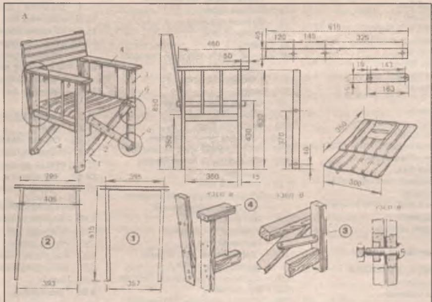
Для него потребуется примерно 10 пог. м рейки типа штакетника с сечением 20x40 или 20x50 мм, около 1,5 м тентовой ткани, парусины или другого прочного материала (при ширине 90 см), 6 болтов диаметром 6-8 мм и длиной 50-60 мм (с полукруглой головкой), шурупы с потайной головкой и мебельные гвозди. Необходимо также заготовить 4 металлических либо деревянные планки размером 163x15x2 мм. Они должны придать конструкции необходимую жесткость (см. узел 6).
